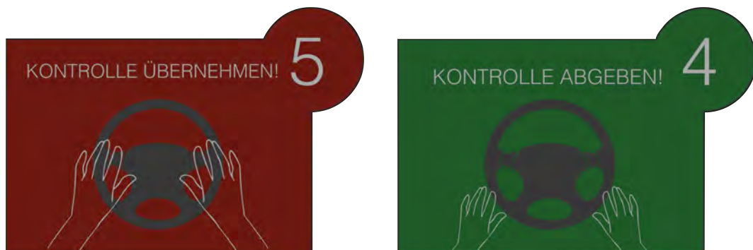
Abbildung 3.5: Darstellung der Konzeption des Take-Over Request; Links: Übernahme der Kontrolle– Rechts: Abgabe der Kontrolle an des Fahrzeug
